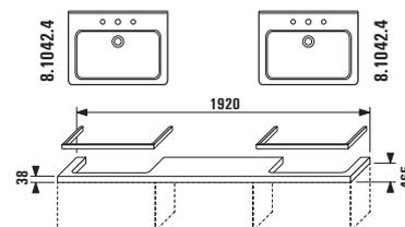
**Предупреждение:** Изолированные ящики под столешницу требуют соответствующего крепления (см. инструкцию по монтажу). Все столешницы под раковину с отверстиями под смеситель можно комбинировать только с раковиной CUBITO 65 см (8.1042.4).
